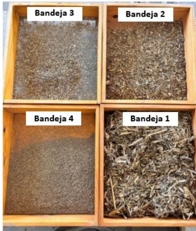
**Figura 7:** Bandejas de análisis de tamaño de partículas (Penn State) en el silo Lote B.
